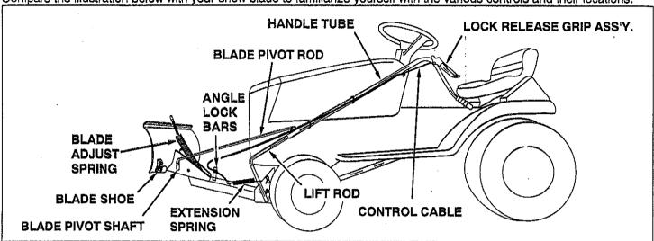
LOCK RELEASE GRIP ASS'Y. HANDLE TUBE **BLADE PIVOT ROD** ANGLE LOCK BARS BLADE ADJUST SPRING **BLADE SHOE** BLADE PIVOT SHAFT **EXTENSION SPRING** LIFT ROD
