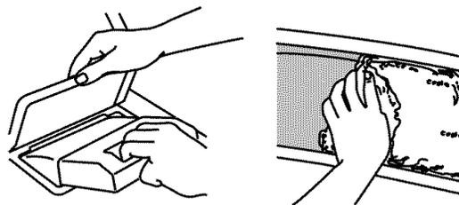
2. Remettre le filtre à charpie en le poussant fermement en place.
