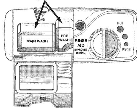
Ne pas utiliser de détergent avec le cycle Rinse Only (Rinçage seulement) (certains modèles). Laisser le couvercle du distributeur de détergent ouvert lors du cycle Rinse Only (certains modèles).
