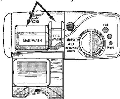
No use detergente con el ciclo 'Rinse Only' (Enjuague Solamente) (modelos selectos). Deje abierta la tapa del compartimiento del detergente cuando use el ciclo 'Rinse Only' (modelos selectos).
