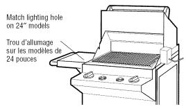
que vous désirez allumer, à la position LITE (allumage). Si le brûleur ne s'allume pas en quatre secondes, tourner le bouton à OFF (arrêt). Attendre 5 minutes et essayer de nouveau. Si le brûleur ne s'allume pas après plusieurs essais, voir la solution pour résoudre le problème au verso de ce guide.
