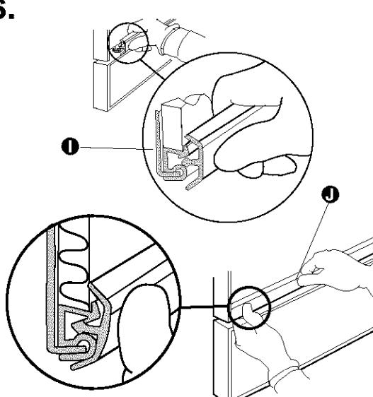
Snap one end of retainer into channel as shown **I**. Push inward while sliding thumb along full length of retainer **J**.Inserte un extremo del retenedor en la acanaladura como se muestra **I**. Empuje hacia adentro mientras desliza el pulgar a todo lo largo del retenedor **J**.Emboîter l'extrémité de la moulure de retenue dans le profilé tel qu'illustré **I**. Pousser en faisant glisser le pouce sur toute la longueur de la moulure de retenue **J**.
