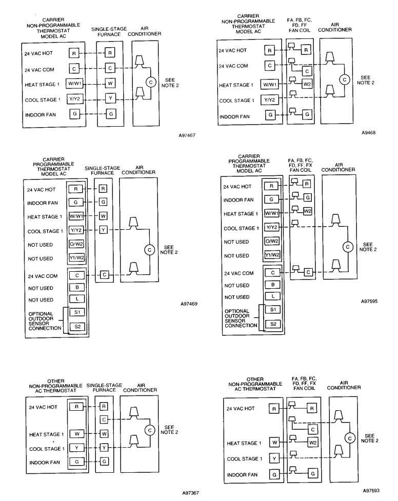
Fig. 5—24-v Control Circuit Connections
