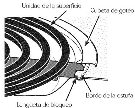
Una vez ubicada correctamente, la lengüeta de bloqueo se debería trabar en el borde de la estufa, a través de la muesca de la cubeta de goteo.
