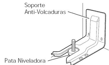
o el panel de protección se pueden retirar para una fácil inspección. Si no es posible realizar una inspección visual, deslice la cocina hacia adelante, confirme que el soporte anti-volcaduras esté ajustado de forma segura al piso o la pared, y deslice la cocina hacia atrás de modo que la pata niveladora trasera se encuentre debajo del soporte anti-volcaduras.
