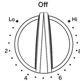
Tanto en **Off (Apagado)** como en **Hi (Alto)**, el control se ajusta en la posición. Es posible que escuche leves sonidos de ajuste durante la cocción, indicando que el control está manteniendo su configuración deseada. Asegúrese de girar la perilla de control a **Off (Apagado)** cuando finalice la cocción.
