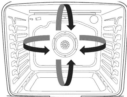
Avec la cuisson par convection, la plupart des aliments peuvent être cuits à une température de 25°F (15°C), plus basse que dans un four thermique standard, et la durée de cuisson peut être diminuée jusqu'à 30 %.
