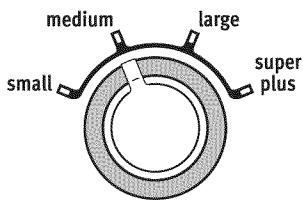
Sélectionner le réglage de niveau d'eau le plus adapté à la charge. Small (petite) ajoute une faible quantité d'eau pour les charges plus petites et Super Plus (ultra grande) ajoute la quantité d'eau la plus importante pour les grandes charges ou les charges volumineuses. Les articles doivent pouvoir se déplacer librement.
