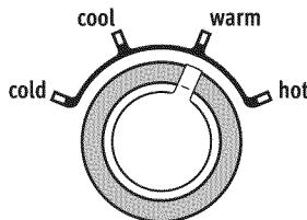
Après avoir sélectionné un programme, sélectionner la température de lavage désirée en tournant le bouton de température au réglage adapté à la charge à laver. Tous les rinçages se font à l'eau froide.
