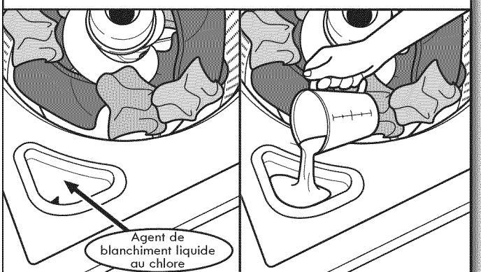
Ne pas remplir excessivement le distributeur, diluer le produit ou utiliser plus d'une 236 mL (1 tasse). Ne pas utiliser d'agent de blanchiment sans danger pour les couleurs ni de produit Oxi avec un programme utilisant de l'eau de Javel.
