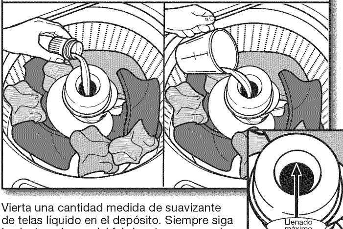
Vierta una cantidad medida de suavizante de telas líquido en el depósito. Siempre siga las instrucciones del fabricante para usar la cantidad correcta de suavizante de telas según el tamaño de la carga.
