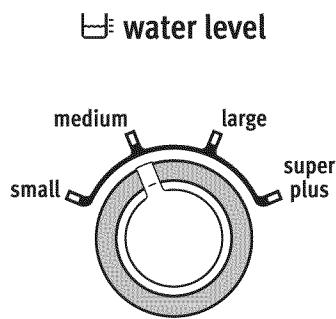
Seleccione el ajuste de nivel de agua más adecuado para su carga. En el nivel de agua para carga Small (Pequeña) se agregará una pequeña cantidad de agua para las cargas pequeñas y en el de Super Plus (Muy grande) se agregará la mayor cantidad de agua para las cargas grandes o voluminosas. Los artículos deben moverse libremente.
