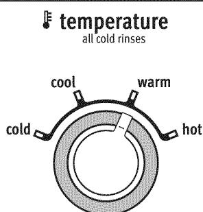
Una vez que haya seleccionado un ciclo, seleccione la temperatura de lavado deseada girando la perilla de Temperature (Temperatura) hacia el ajuste apropiado, según la carga. Todos los enjuagues son con agua fría.
