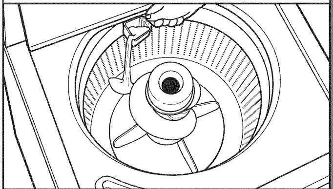
Agregue una cantidad medida de detergente en el fondo de la canasta de la lavadora antes de agregar las prendas. Si va a usar un producto para realizar el lavado, como Oxi o blanqueador no decolorante, agréguelo también al fondo de la canasta de lavado.
