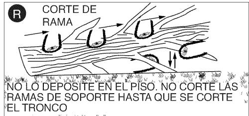
el tronco del piso. Extraiga las ramas pequeñas en un solo corte. Las ramas tensionadas se deben cortar desde abajo hacia arriba para evitar que la sierra de cadena se trabe. Rebaje las ramas del lado opuesto manteniendo el tronco del árbol entre usted y la sierra. Nunca realice cortes entre las piernas o se siente a horcajadas sobre la rama que cortará.
