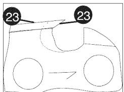
4. **(Figura Y)** Afile las cortadoras (24) primero del lado de la cadena. Lime desde la cara interna de cada cortadora hacia afuera. Después gire la sierra y repita los procesos (2,3,4) para las cortadoras del otro lado de la cadena. Utilice una lima plana para limar las partes superiores de los dientes rastrilladores (parte de la unión de la cadena en el frente de la cortadora) para que estén a 0,63 mm (0,025 pulg.) por debajo de las puntas de las cortadoras.
