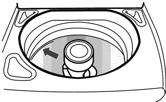
3. Verser la quantité mesurée d'agent de blanchiment au chlore liquide le distributeur d'agent de blanchiment au chlore liquide, si nécessaire. L'agent de blanchiment est dilué et automatiquement distribué au moment approprié au cours du programme de lavage.
