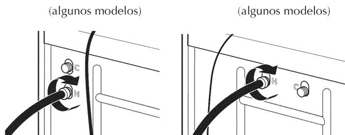
4. Usando los alicates, apriete los acoplamientos dos tercios de vuelta adicional.
