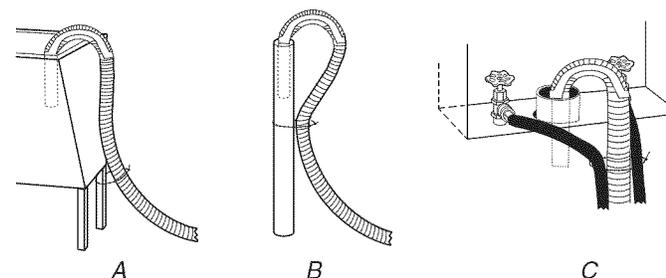
Si los grifos de la lavadora y el tubo vertical de desagüe están empotrados, ponga el extremo en forma de gancho de la manguera de desagüe en el tubo vertical. Enrolle con firmeza el fleje rebordeado alrededor de las mangueras de entrada del agua y la manguera de desagüe. Vea la ilustración C.
