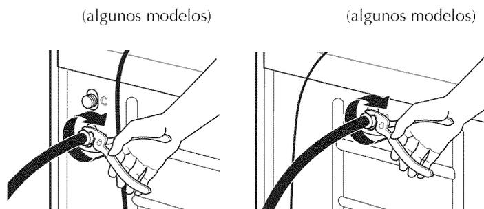
5. Conecte la manguera de agua fría a la válvula de entrada del agua superior o derecha de acuerdo al modelo.
