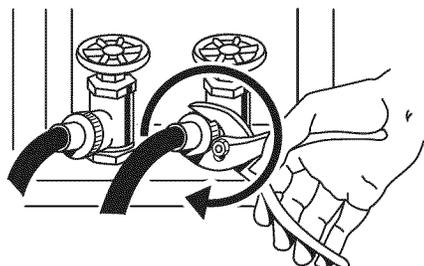
**NOTA:** Use el extremo de la manguera que tiene arandela plana (sin filtro) para conectar las mangueras a su lavadora. No apriete demasiado ni use cinta o selladores en la válvula. Se pueden dañar las válvulas.
