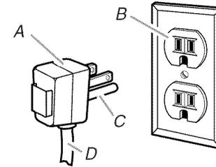
A. Enchufe de 3 terminales con conexión a tierra
