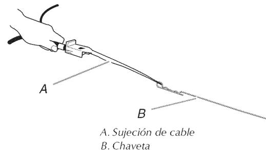
4. Para quitar el cable de suministro de energía de la sujeción de cable, empuje el cable hacia adentro, presione TAB (lengüeta) y luego jale el cable hacia fuera.
