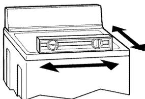
4. Si la lavadora no está nivelada, muévala ligeramente hacia fuera, inclínela hacia atrás, levante la parte delantera de la lavadora con el bloque de madera y ajuste las patas hacia arriba o hacia abajo según sea necesario girándolas. Gire las patas hacia la derecha para levantar la lavadora o hacia la izquierda para bajarla. Repita los pasos 1 a 4 hasta que la lavadora esté nivelada.
