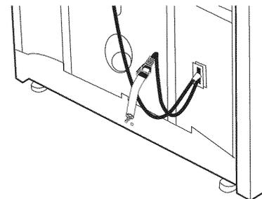
2. Tome con firmeza el cable de suministro de energía y jálelo para quitar por completo el cable de suministro de energía, la sujeción de cable y la chaveta del panel posterior.
