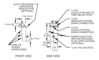
Fig. 5 - Condensate Trap
