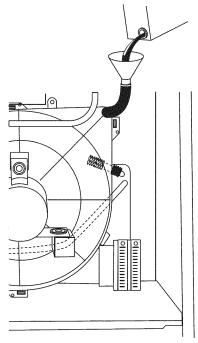
Fig. 49 - Filling Condensate Trap
