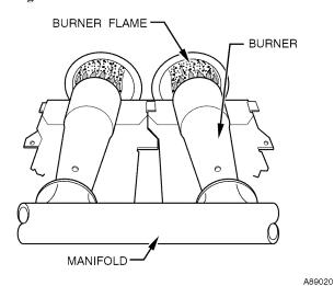
Fig. 59 - Burner Flame
