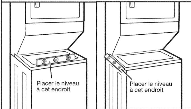
Une fois la laveuse/sécheuse est à son emplacement final, placer un niveau sur les bords supérieurs de la laveuse/sécheuse. Utiliser une rive latérale comme guide pour déterminer l'aplomb des côtés. Vérifier l'aplomb de l'avant à l'aide du couvercle, tel qu'indiqué. Faire bouger la laveuse/sécheuse d'avant en arrière pour s'assurer que les quatre pieds sont bien en contact avec le plancher. Si la laveuse/sécheuse est d'aplomb, passer à l'étape 2.
