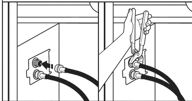
Fixer le tuyau d'eau chaude à la valve d'arrivée d'eau en bas. Visser le raccord à la main jusqu'à ce qu'il soit bien serré. Serrer les raccords de deux tiers de tour supplémentaires à l'aide d'une pince. Répéter pour le robinet d'arrivée d'eau froide (robinet supérieur).
