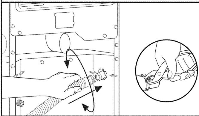
Ouvrir la bride de serrage. Tourner le tuyau d'un côté et de l'autre en poussant sur le raccord de vidange sur le côté de la laveuse/sécheuse. Continuer jusqu'à ce que le raccord touche les butées nervurées sur le placard. Placer la bride à l'endroit indiqué "CLAMP". Relâcher la bride.
