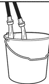
Faire couler l'eau par les tuyaux dans l'évier de buanderie, le tuyau de rejet à l'égout ou le seau pendant quelques secondes pour éviter toute obstruction. On doit laisser couler l'eau jusqu'à ce qu'elle soit limpide.
