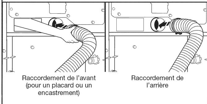
Raccordement de l'avant (pour un placard ou un encastrément)
