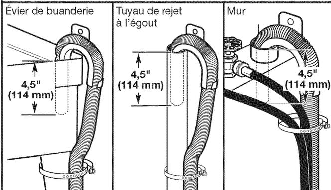
Fixer le tuyau de vidange au pied de l'évier de buanderie, au tuyau de rejet à l'égout ou aux tuyaux d'arrivée d'eau pour le tuyau de rejet à l'égout mural avec la sangle d'expédition retirée précédemment.
