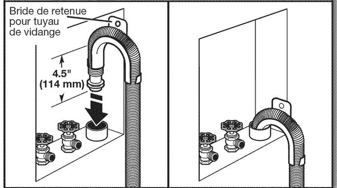
Placer le tuyau dans le tuyau de rejet à l'égout (illustré sur l'image) ou par-dessus le côté de l'évier de buanderie.
