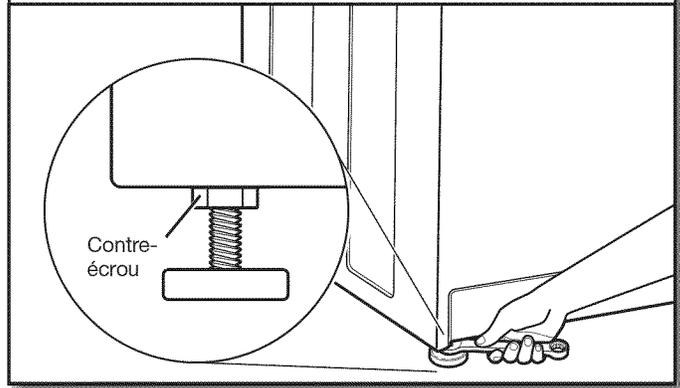
Une fois l'aplomb de la laveuse/sécheuse établi, utiliser une clé plate ou une clé à molette de 9/16" ou 14 mm pour tourner les contre-écrous sur les pieds de nivellement dans le sens anti-horaire et les serrer fermement contre la caisse de la laveuse/sécheuse.
