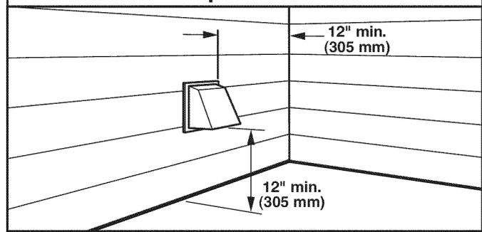
Installer un clapet d'évacuation et calfeutrer l'ouverture murale à l'extérieur autour du clapet d'évacuation.
