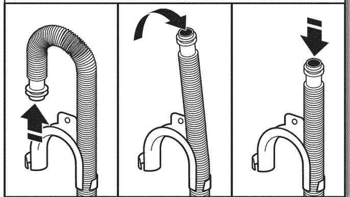
Pour les installations avec vidange au plancher, il faut retirer la bride de retenue pour tuyau de vidange de l'extrémité du tuyau de vidange. Des pièces supplémentaires avec des directives distinctes seront peut-être nécessaires. Voir "Outillage et pièces".
