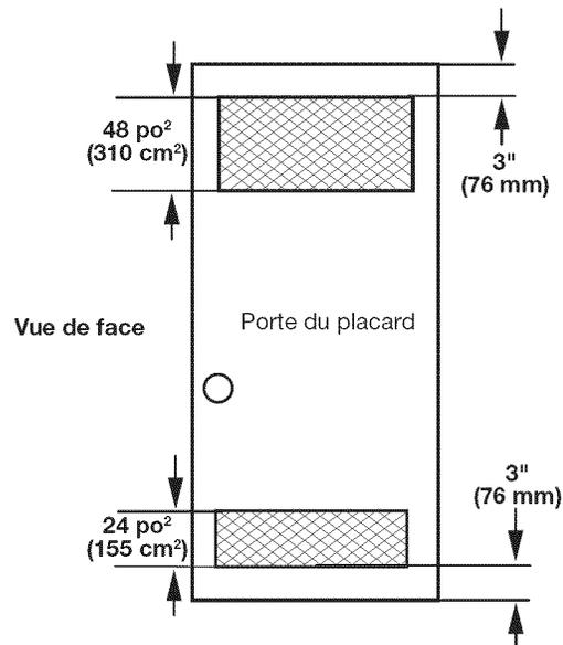
On recommande les dimensions d'espacement ci-dessus pour cette laveuse/sècheuse. Cette laveuse/sècheuse a été testée pour une installation avec des dégagements de 0" (0 mm) sur les côtés. L'espacement recommandé doit être considéré pour les raisons suivantes :
