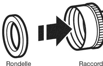
Insérer une nouvelle rondelle plate dans chaque extrémité des tuyaux d'arrivée d'eau (non fournis). Insérer fermement les rondelles dans les raccords.
