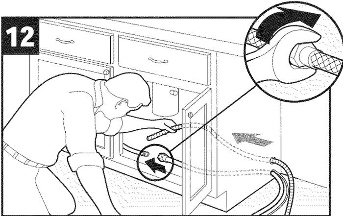
Attach waterline to hot water supply./Conecte la tubería de agua al suministro de agua caliente./Raccordez la canalisation d'eau à la canalisation d'approvisionnement de l'eau chaude.
