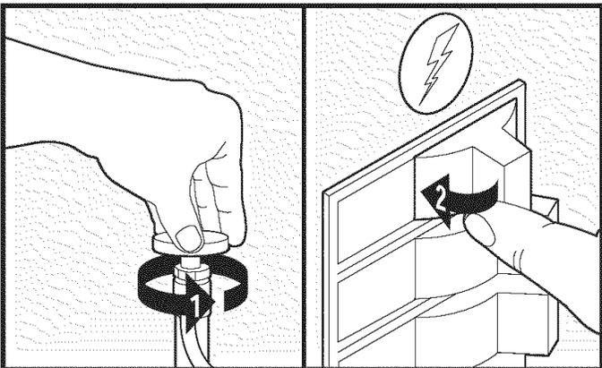
Before installation turn off water and power./Antes de la instalación, cierre el suministro de agua y desconecte el suministro eléctrico./Avant l'installation, fermez l'eau et coupez le courant.
