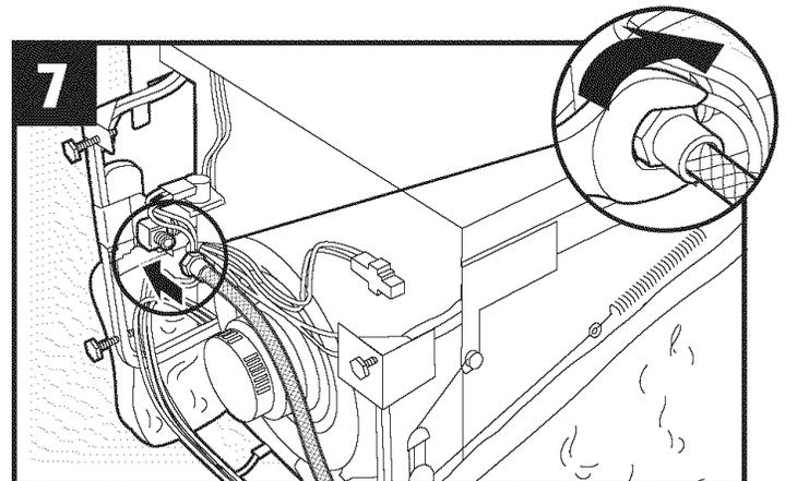
Connect water line if using a flexible braided line. For solid copper line connection refer to step 19./Conecte la tubería de agua usando un conducto tejido flexible. Consulte el paso 19 para la conexión de tuberías de cobre sólido./Raccordez la canalisation d'eau en utilisant un tuyau tressé flexible. Pour le raccordement avec une canalisation en cuivre, reportez-vous à l'étape 19.
