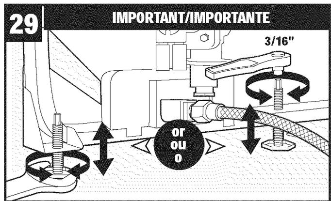
If not level adjust feet. /Si no está nivelado, ajuste las patas. /S'il n'est pas de niveau, ajustez les pieds.
