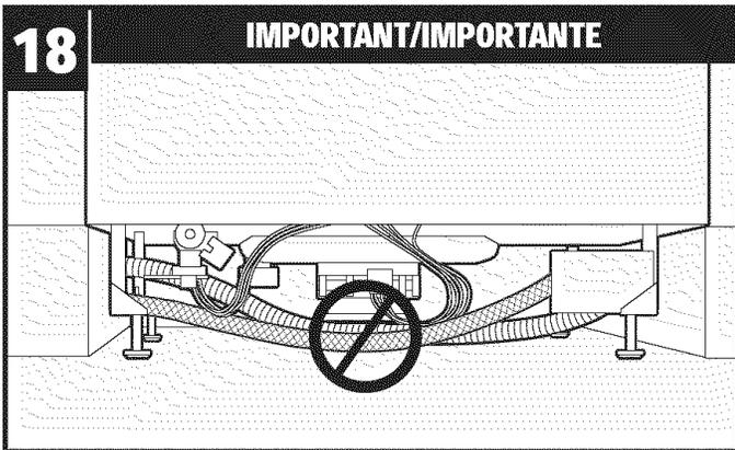
Never route cord or hoses under motor / Nunca coloque el cordón eléctrico ni las mangueras por debajo del motor / Ne jamais faire passer câbles ou tuyaux flexibles sous le moteur.
