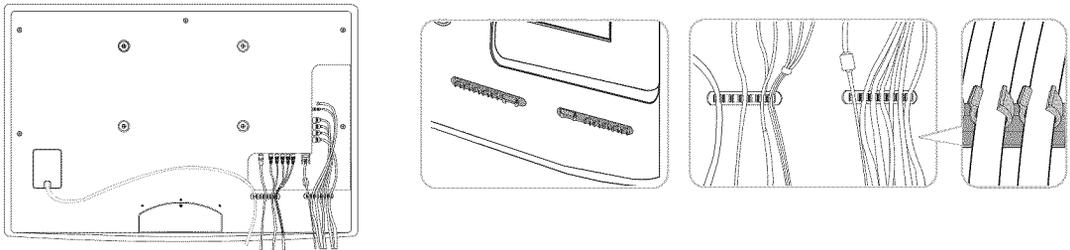
⚠ Ne tirez pas trop fort sur les câbles lorsque vous les disposez. Cela peut causer des dommages aux bornes de connexion du produit.
