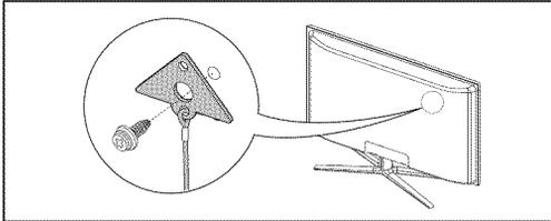
2. Vissez à fond les vis sur le mur ou l'armoire où le téléviseur doit être installé. Pour immobiliser le téléviseur, fixez le cordon relié au téléviseur aux vis vissées dans le mur ou sur l'armoire.
