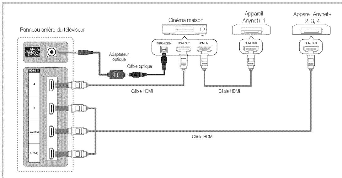
1. Raccordez la prise HDMI IN(1(DVI), 2(ARC), 3 ou 4) du téléviseur à la prise de sortie HDMI OUT de l'appareil Anynet+ correspondant à l'aide du câble HDMI.
