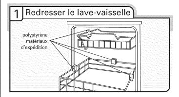
Redresser le lave-vaisselle. Ouvrir la porte et retirer le polystyrène, la tour de carton et tout autre matériau d'expédition. Fermer la porte du lave-vaisselle. Fermer la porte du lave-vaisselle en l'enclenchant pour la verrouiller.
