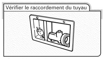
3. Tirer vers le bas sur le collet de blocage tout en poussant le raccord sur l'adaptateur pour robinet.
