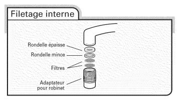
Insérer les deux filtres, la rondelle mince, puis la rondelle épaisse de l'ensemble de l'adaptateur pour robinet dans l'adaptateur pour robinet. Fixer l'adaptateur sur l'extrémité du robinet.
