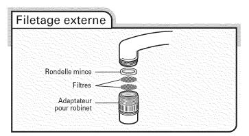
Insérer les deux filtres, puis la rondelle mince de l'ensemble de l'adaptateur pour robinet dans l'adaptateur pour robinet. Fixer l'adaptateur sur l'extrémité du robinet.
