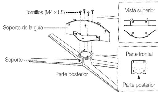
1. Conecte el soporte de la guía con el soporte mediante los cuatro tornillos (M4 x L8), tal como se muestra.
