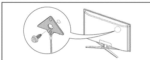
2. Apriete firmemente el tornillo en la pared o el mueble donde se instala el televisor. Asegure el soporte al televisor y al tornillo de la pared o el mueble.
