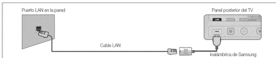
Si dispone de red dinámica, debe usar un enrutador o módem ADSL que admita el protocolo de configuración dinámica de host (DHCP). Los módems y los enrutadores compatibles con DHCP proporcionan automáticamente la dirección IP, la máscara de subred, la puerta de enlace y los valores de DNS que el televisor necesita para acceder a Internet, de manera que no es necesario especificarlos manualmente. La mayoría de las redes domésticas son dinámicas.
