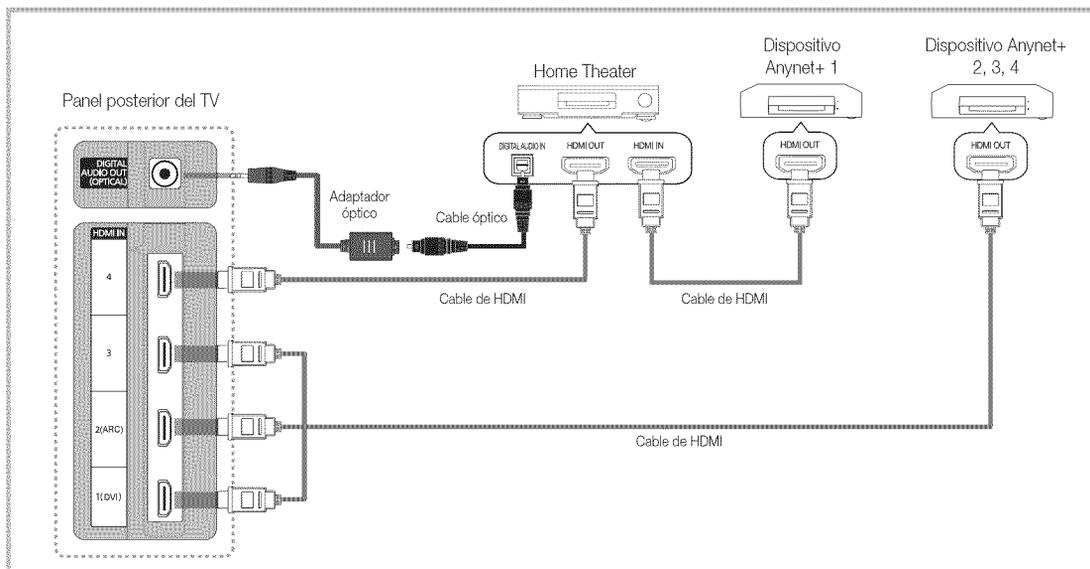
1. Conecte los terminales HDMI IN (1(DVI), 2(ARC), 3 o 4) del televisor y el terminal HDMI OUT del dispositivo Anynet+ correspondiente mediante un cable HDMI.
