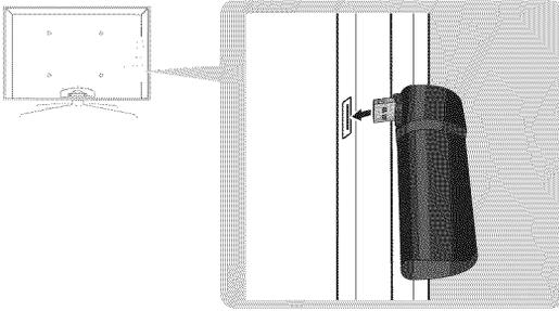
Para conectar el adaptador de LAN inalámbrico de Samsung mediante el adaptador USB en ángulo recto siga estos pasos:
