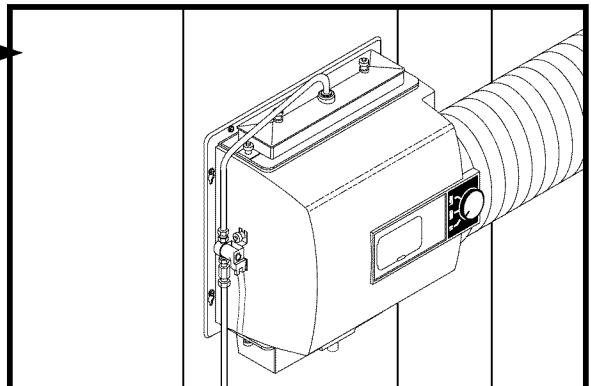
Attacher la vanne électromagnétique sur le côté du boîtier de l'humidificateur avec la flèche de débit orientée vers le haut, à l'aide des vis allées fournies. Ne pas inverser les raccords en laiton car le robinet ne fonctionnera pas adéquatement si l'écoulement se fait en sens inverse. Monter le tuyau du distributeur de façon qu'il se dirige vers l'ouverture centrale du couvercle du bac de distributeur.
