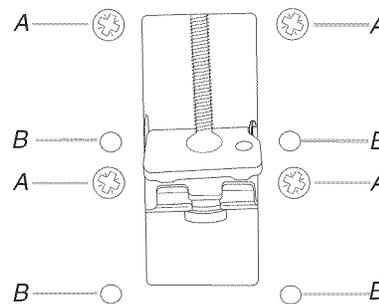
A. Réglage supérieur - installé à l'usine
