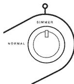
Le bouton de commande de mijotage a deux réglages : SIMMER (mijotage) et NORMAL. Lorsque la commande est réglée sur NORMAL, la zone de cuisson ou l'élément avant gauche fonctionnera comme élément simple ou double (sur certains modèles).
