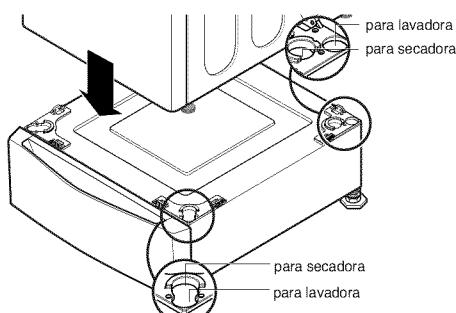
**NOTA:** las patas de la lavadora y la secadora no son iguales, por lo que los huecos de las abrazaderas de la parte superior del pedestal son alargados. Consulte la ilustración anterior para identificar las distintas ubicaciones para las patas de la lavadora y la secadora. Si las patas no se encuentran en las ubicaciones correctas, el electrodoméstico no quedará bien alineado y no podrá fijarse al pedestal.
