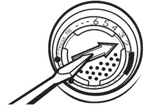
**REMARQUE :** Pour une majorité de types d'eau, le réglage effectué à l'usine à 2 donnera de bons résultats. Si l'eau du domicile est dure ou si on remarque la présence d'anneaux ou de taches, essayer un réglage plus élevé. Tourner l'ajusteur à flèche à l'intérieur du distributeur soit à la main, soit en insérant un tournevis à lame plate au centre de la flèche et en tournant.
