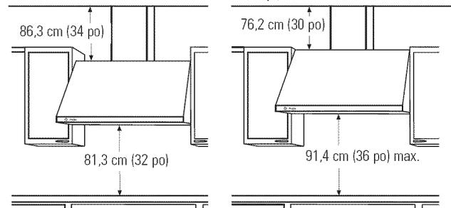
**Plafond de 3,0 m (10 pi) :** Installez la hotte à une hauteur d'au moins 81,3 cm (32 po) et d'au plus 91,4 cm (36 po) au-dessus de la surface de cuisson. Le couvre-conduit peut être allongé jusqu'à 86,3 cm (34 po) entre le dessus de la hotte et le plafond.
