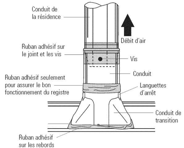
**ATTENTION :** N'utilisez pas de vis à tôle pour fixer le raccord entre le conduit de transition et le conduit. Les vis installées à cet endroit empêcheraient le registre de bouger librement. Scellez le raccord à l'aide de ruban adhésif seulement.
