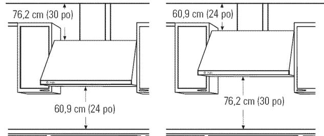
**Plafond de 2,7 m (9 pi) :** Installez la hotte à une hauteur d'au moins 60,9 cm (24 po) et d'au plus 76,2 cm (30 po) au-dessus de la surface de cuisson. Le couvre-conduit peut être allongé pour dissimuler le conduit jusqu'au plafond.
