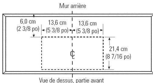
Pratiquez un orifice de 27,3 cm (10 3/4 po) x 21,4 cm (8 7/16 po) sous la retombée de plafond ou l'armoire pour y insérer le conduit de transition, comme indiqué dans l'illustration.
