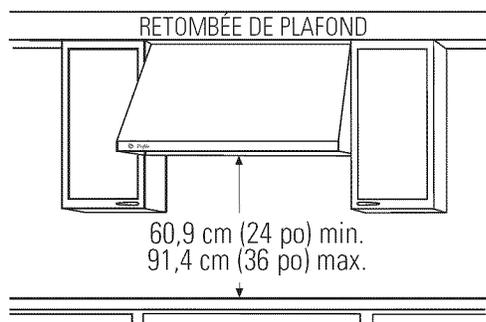
Dans le cas de cette installation, le conduit d'évacuation à la partie supérieure de la hotte sera dissimulé à l'intérieur de la retombée de plafond ou de l'armoire supérieure.
