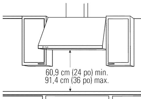
Dans le cas de cette installation, un couvre-conduit décoratif permet de dissimuler le conduit d'évacuation à la partie supérieure de la hotte. L'utilisation d'un couvre-conduit décoratif exige une hauteur d'installation spécifique au-dessus du comptoir. Pour de plus amples renseignements, reportez-vous à la page 12.
