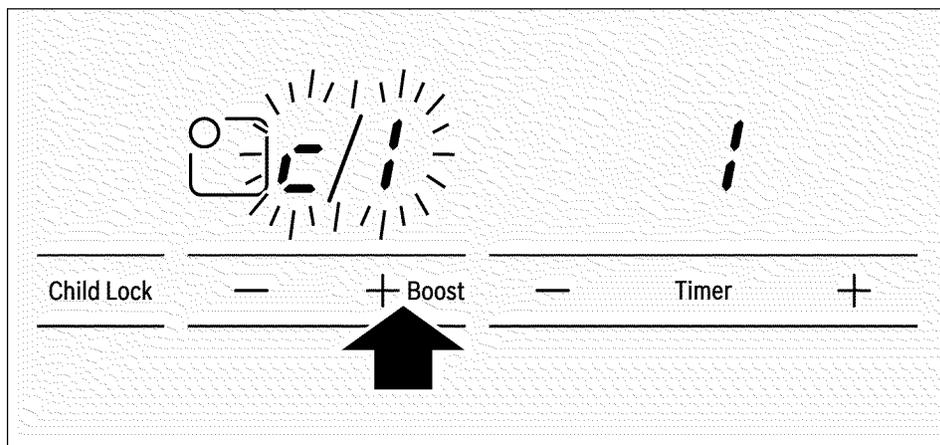
5. Volver a presionar el símbolo **Child Lock**, durante más de 4 segundos, hasta que suene una señal de confirmación. Los ajustes se habrán guardado correctamente.
