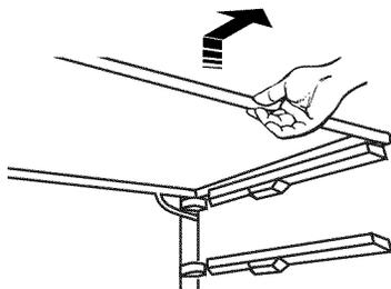
2. Réinstaller la tablette en abaissant les butées de la tablette dans les ouvertures dans la paroi interne du compartiment réfrigérateur. Glisser la tablette complètement jusqu'au fond.
