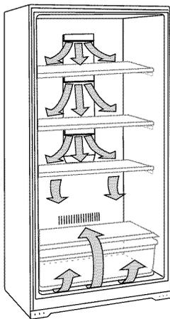
**Ne pas obstruer l'une ou l'autre de ces ouvertures d'aération** avec des aliments emballés. Si les ouvertures d'aération sont bloquées, le courant d'air sera coupé et des problèmes de température et d'humidité peuvent survenir.
