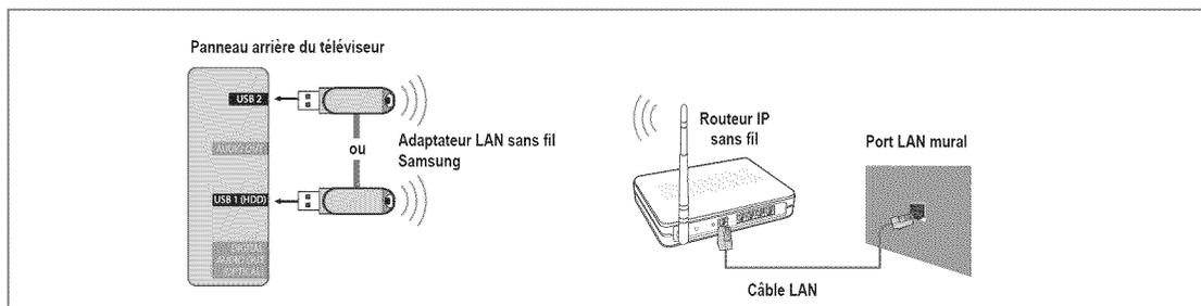
1. Branchez l'adaptateur sans fil LAN Samsung à la borne **USB1(HDD)** ou **USB2** du téléviseur.
