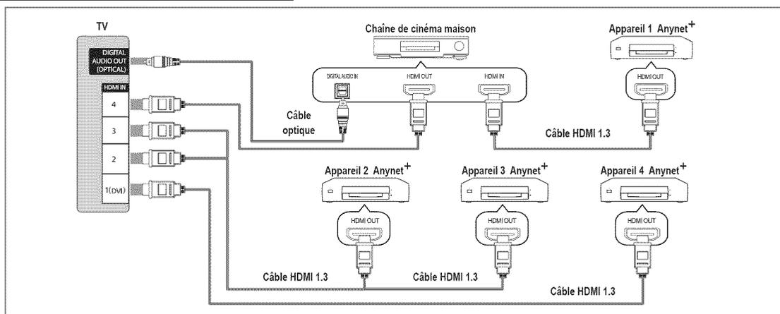
1. Raccordez la prise **HDMI IN (1(DVI), 2, 3 ou 4)** du téléviseur à la prise de sortie **HDMI OUT** de l'appareil Anynet+ correspondant à l'aide du câble HDMI.
