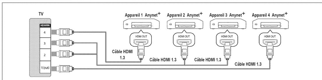
1. Raccordez la prise **HDMI IN (1(DVI), 2, 3 ou 4)** du téléviseur à la prise de sortie **HDMI OUT** de l'appareil Anynet+ correspondant à l'aide du câble HDMI.
