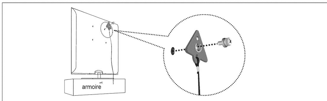
2. Fixez solidement les vis au mur ou à l'armoire auquel sera installé le téléviseur. Fixez le support attaché au téléviseur aux vis sur le mur ou armoire afin d'installer le téléviseur.
