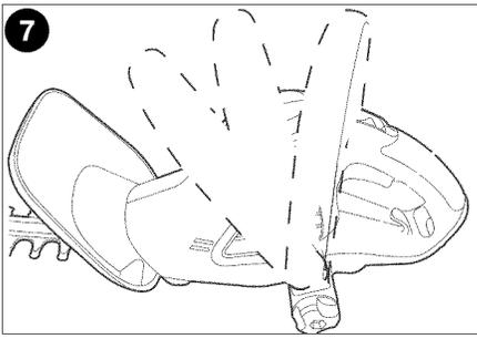
la rallonge en deux à environ 203 mm (8 po) de l'extrémité, puis l'insérer dans la fente située dans la partie inférieure de la poignée. Fixer la boucle ainsi formée en repliant la rallonge sur l'onglet comme montré à la **figure 8**. Tirer délicatement sur la rallonge afin de s'assurer que celle-ci est fermement retenue par la poignée du taille-haie. Insérer les lames du réceptacle du taille-haie dans la fiche de la rallonge (**figure 8**).
