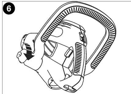
**NOTA:** El mango en el modelo 79442, 51891 se ajusta en tres posiciones diferentes, según se muestra en la **figura 7**. Para mover el mango, desenrosque la perilla de plástico, coloque el mango en la posición deseada y vuelva a ajustar la perilla.
