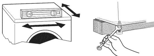
Si la laveuse est placée contre un mur, on doit l'écartier légèrement du mur avant de l'incliner vers l'arrière. Si la laveuse n'est pas d'aplomb, soulever l'avant de la laveuse avec une cale de bois et ajuster la position des pieds selon le besoin; soulever ensuite l'arrière de la laveuse et ajuster la longueur des pieds selon le besoin. Répéter ces opérations jusqu'à l'obtention d'un aplomb correct de la laveuse.
