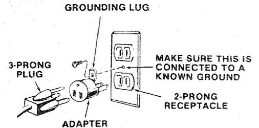
**WARNING: THE GREEN GROUNDING LUG EXTENDING FROM THE ADAPTER MUST BE CONNECTED TO A PERMANENT GROUND SUCH AS TO A PROPERLY GROUNDED OUTLET BOX. NOT ALL OUTLET BOXES ARE PROPERLY GROUNDED.**
