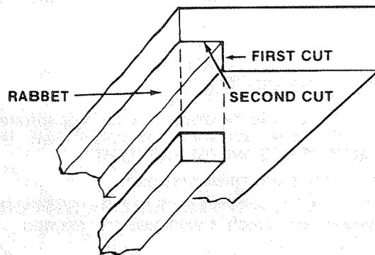
**WARNING: FOR YOUR OWN SAFETY, INSTALL BLADE GUARD IMMEDIATELY UPON COMPLETION OF RABBETING OPERATION.**
