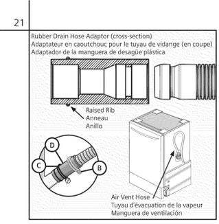
Rubber Drain Hose Adaptor (cross-section) Adaptateur en caoutchouc pour le tuyau de vidange (en coupe) Adaptador de la manguera de desagüe plástica
