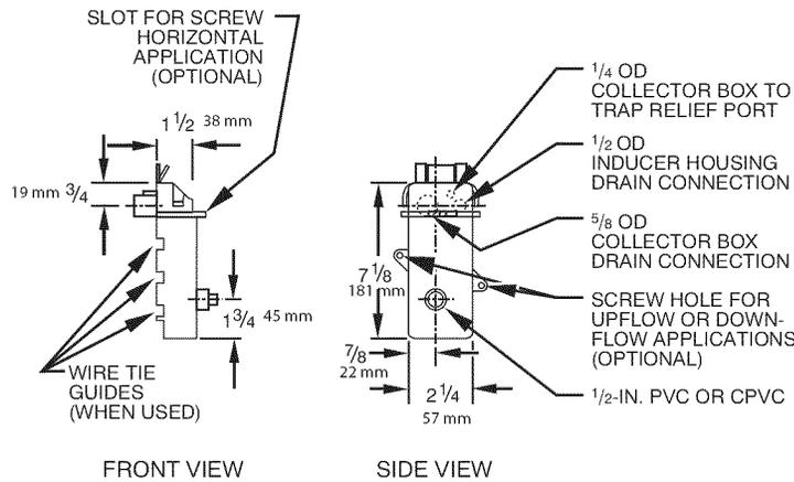
Fig. 5 - Condensate Trap
