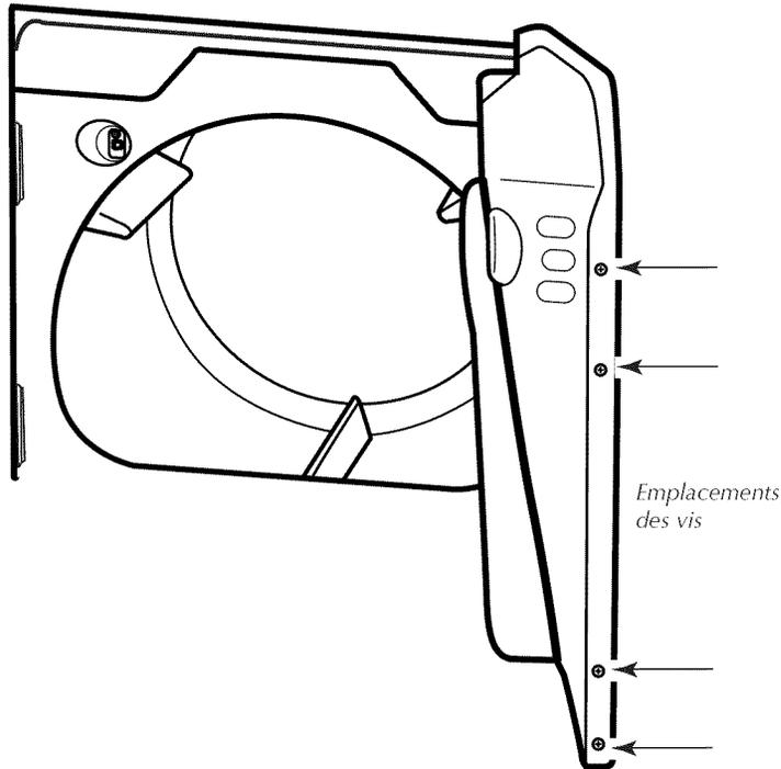
4. Installer les deux (2) charnières sur le panneau avant de la sécheuse à l'aide de quatre (4) vis. Utiliser le côté sans fente pour fixer la charnière sur le panneau avant.
