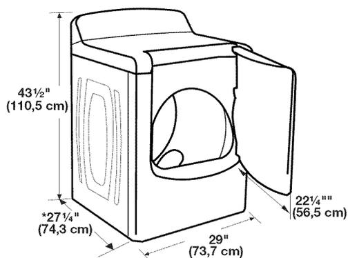
\*La plupart des installations requièrent un espace minimum de 5" (12,7 cm) derrière la sècheuse pour le conduit d'évacuation avec coude. Voir "Exigences concernant l'évacuation".
