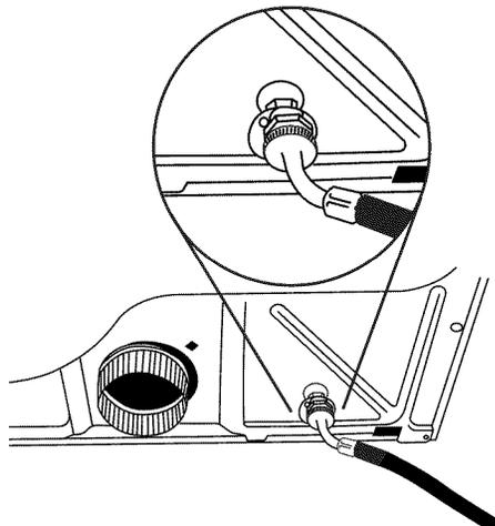
**REMARQUE :** Ne pas serrer excessivement. Le raccord risque d'être endommagé.
