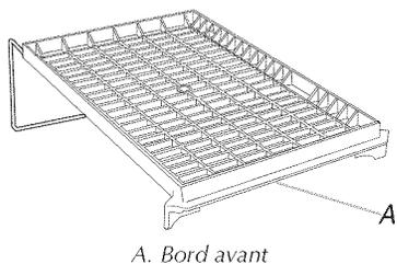
2. Placer la grille de séchage dans le tambour de la sècheuse en positionnant la broche arrière sur le rebord du panneau interne arrière de la sècheuse. Baisser le bord avant de la grille de séchage pour bien la fixer par-dessus le filtre à charpie.
