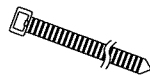
Attache pour maintenir le tuyau de vidage au tuyau, tuyau d'entrée ou bac à lessive
