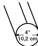
2. Utiliser un clapet d'évacuation de 4" (10,2 cm).
