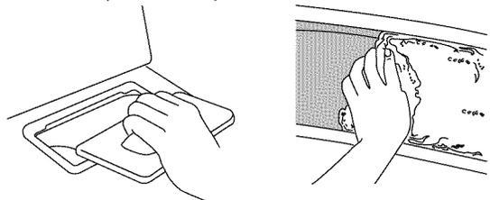
2. Remettre le filtre à charpie en le poussant fermement en place.
