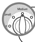
Ajuster en fonction du volume de la charge. Les charges doivent pouvoir culbuter librement. Pour modifier le niveau d'eau après le début de l'action de lavage, tourner le bouton au réglage désiré.
