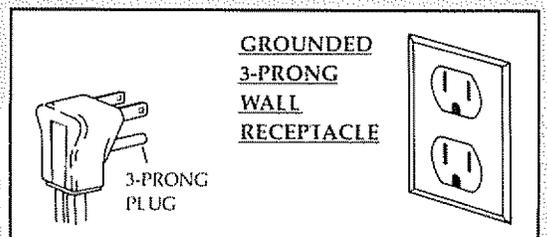
**DO NOT REMOVE GROUND PLUG UNDER ANY CIRCUMSTANCES. DO NOT USE AN EXTENSION CORD.**
