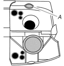
**REMARQUE :** Pour une majorité de types d'eau, le réglage effectué à l'usine à 2 donnera de bons résultats. En cas d'eau dure ou d'observation d'anneaux ou dépôts, essayer un réglage plus élevé. Tourner l'ajusteur à flèche à l'intérieur du distributeur soit à la main, soit en insérant un tournevis à lame plate au centre de la flèche et en tournant.
