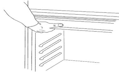
2. Pousser contre la zone du joint du châssis avant pour introduire le four dans le placard, jusqu'à ce que les pieds installés pour l'expédition soient presque au contact du placard.
