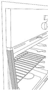
8. Appuyer pour insérer chaque pièce de garniture et la mettre en place à l'extrémité inférieure.
