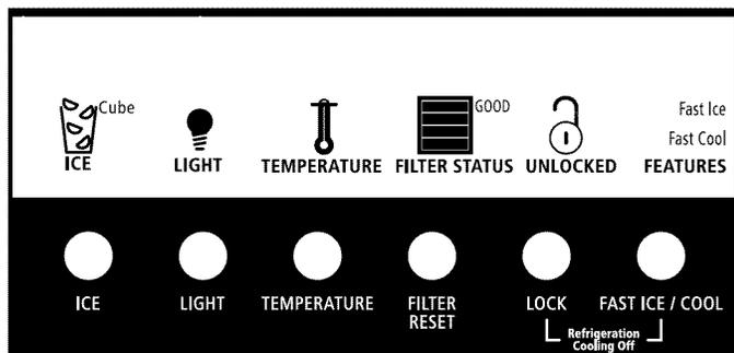
Pour désactiver le refroidissement, appuyer simultanément pendant 3 secondes sur les touches LOCK (verrouillage) et FAST ICE/COOL (glace/refroidissement rapide). Appuyer de nouveau sur les touches LOCK (verrouillage) et FAST ICE/COOL (glace/refroidissement rapide) pour mettre en marche le refroidissement. Votre réfrigérateur et votre congélateur ne se refroidissent pas lorsque le refroidissement est désactivé.
