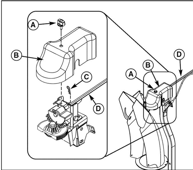
**Figure 30. Spout Rotator Rod**
