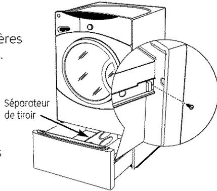
**C** Réinstallez les vis originales dans chaque glissière de tiroir. Resserrez les deux vis.
