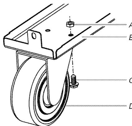
A. Écrou indesserrable C. Vis à tête hexagonale  $\frac{5}{16}$ —18 x  $\frac{7}{8}$ "
