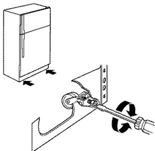
3. Ouvrir les deux portes de nouveau et s'assurer qu'elles se ferment aussi facilement que vous le désirez. Sinon, incliner le réfrigérateur un peu plus vers l'arrière en tournant les deux vis de nivellement vers la droite. Plusieurs tours peuvent être nécessaires et vous devez tourner les deux vis de nivellement d'un espace égal.
