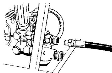
**NOTA:** Siempre mantener la manguera alejada del tubo de escape del motor.
