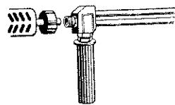
6. Cortar el amarre de la manguera para alta presión. Desenrollar la manguera y conectar el extremo roscado a la pistola.
