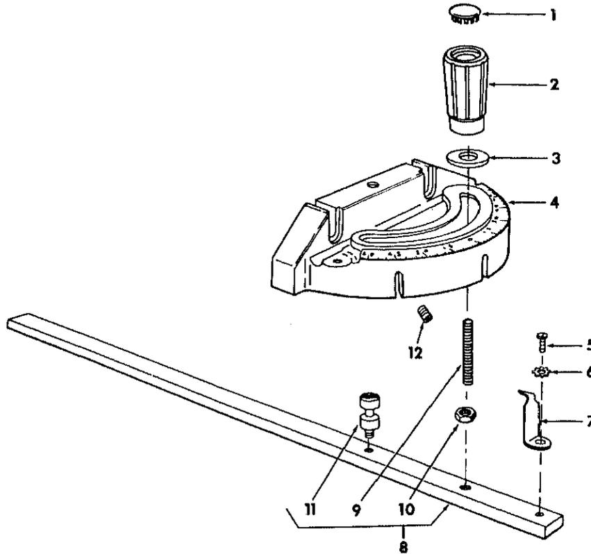
FIGURE 4 – 62694 MITER GAUGE ASSEMBLY
