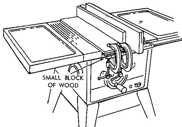
2. INSTALL BLADE GUARD IMMEDIATELY UPON COMPLETION OF THE RESAWING OPERATION.
