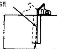
SHOULD BE NO GAP OR OVERLAP WHEN SQUARE IS FLIPPED OVER IN DOTTED POSITION
