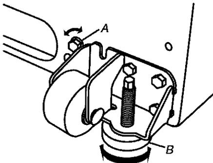
A. Vis de réglage des roulettes arrière
