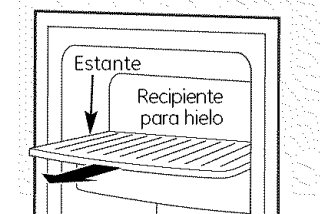
Para alcanzar el interruptor eléctrico.
