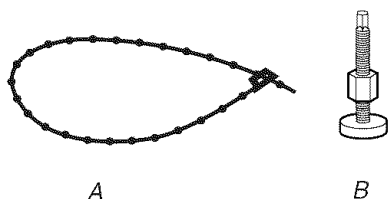
A. Attache de fixation perlée B. Pieds de nivellement avant avec écrous (2)
